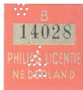
Licentieplaatjes op een Aetherkruiser AK401, met het ingeposte cijfer 4 (exclusief de neon-afstemindicator bevat dit toestel 4 lampen).
