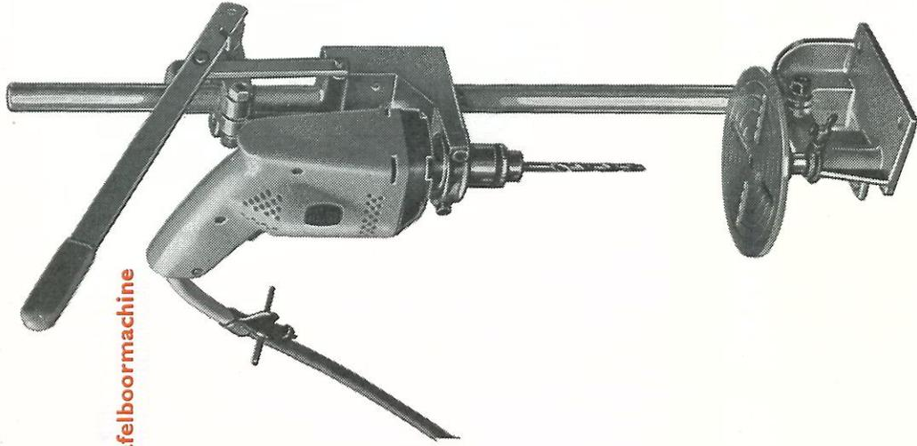
Door de Heemmaster in de verticale standaard te spannen, wordt een praktische tafelboormachine verkregen. Hiermede kunnen snel en gemakkelijk gaten in metaal, hout, plastics, enz. worden geboord. De hefboom laat boormachine en boor neer op het werkstuk. Dit vereenvoudigt het werken en verhoogt de nauwkeurigheid. Ook de tafel is op hoogte instelbaar.
