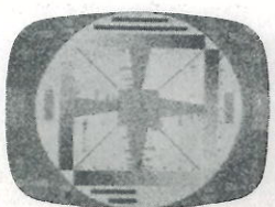
Zwak signaal (bijv. defecte antenne)
