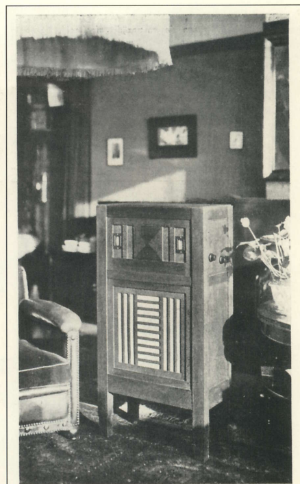
ERRES K.Y. 112, EEN VIER-LAMPSWISSELSTROOM TOESTEL MET INGEBOUWDE ELECTRO-DYNAMISCHEN LUIDSPREKER f 325.--.
